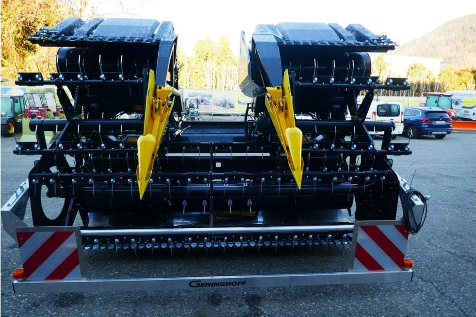
Klappbares Geringhoff Schneidwerk, 3-teiliges Getreideschneidwerk Harvest Star, 5,4 m Arbeitsbreite, Farbe Schwarz-Gelb, hydraulischer Haspelantrieb mit Anbauteile für New Holland, prompt verfügbar
