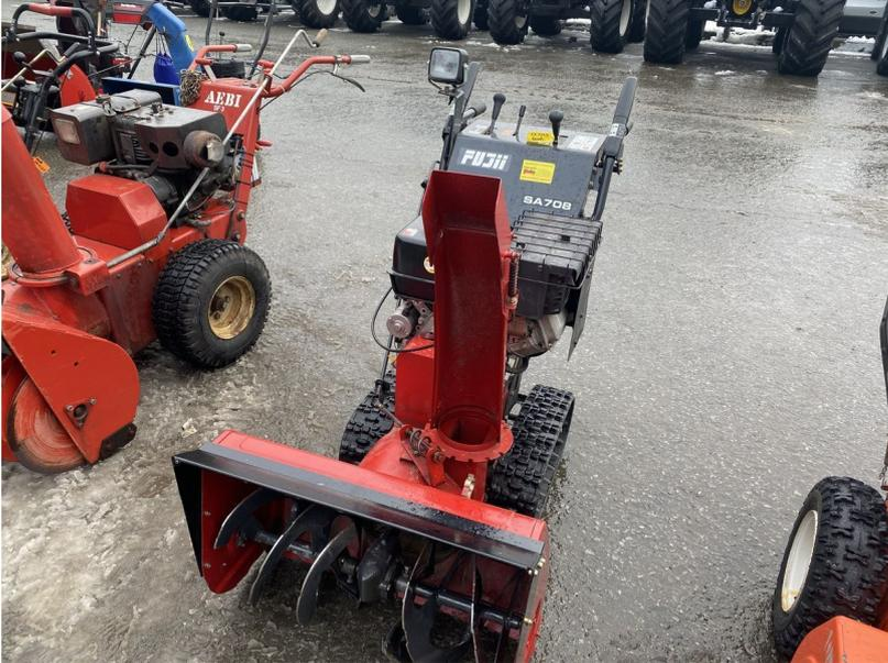
Die Fuji SA 708ME ist eine Schneefräse mit E-Starter für den Heimgebrauch. Sie verfügt über eine Leistung von 8 PS und eine Fräsbreite von 71 cm. Diese Schneefräse ist leicht und kompakt, was sie ideal für den Einsatz auf kleinen Gehwegen und Einfahrten macht. Die SA 708ME verfügt über einen verstellbaren Auswurfkanal, der eine einfache Anpassung an Ihre Bedürfnisse ermöglicht. Sie ist auch mit einem Griff ausgestattet, der eine bequeme Verwendung ermöglicht, auch bei längeren Einsätzen.
