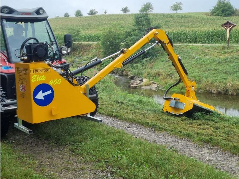
Frontoni ELITE 400 Böschungsmäher, 4m Reichweite , elektrischer Joystick
