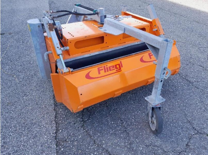
AB 135cm, Frontanbau, Stützrad vorne, Antrieb 1DW Steuergerät, mech. Schwenkbar, Hydr. Schmutzwanne
