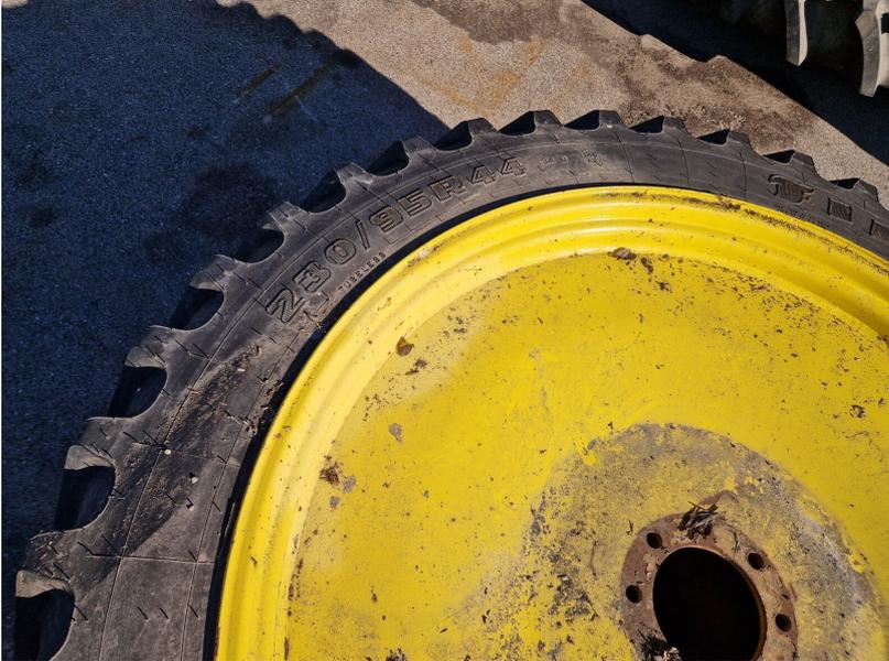
Klassifizierung: Gebrauchtmachine; Reifentyp: Rad; Anbauposition der Räder/Reifen: kompletter Satz; Hinterreifen Größe: 230/95R44; Weitere Maschinenmerkmale: Nabendurchmesser 155mm, 203mm Lochkreisdurchmesser, 8 Bolzen
