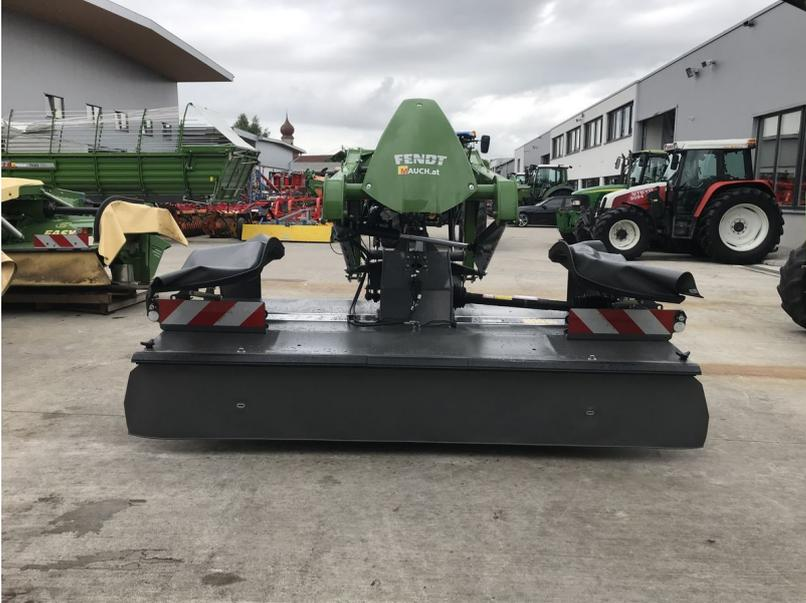
Fendt Slicer 310 FQ, Komfortpaket, Beleuchtung, hydr. klappbarer Außenschutz, hydr. Seitenvershub.
