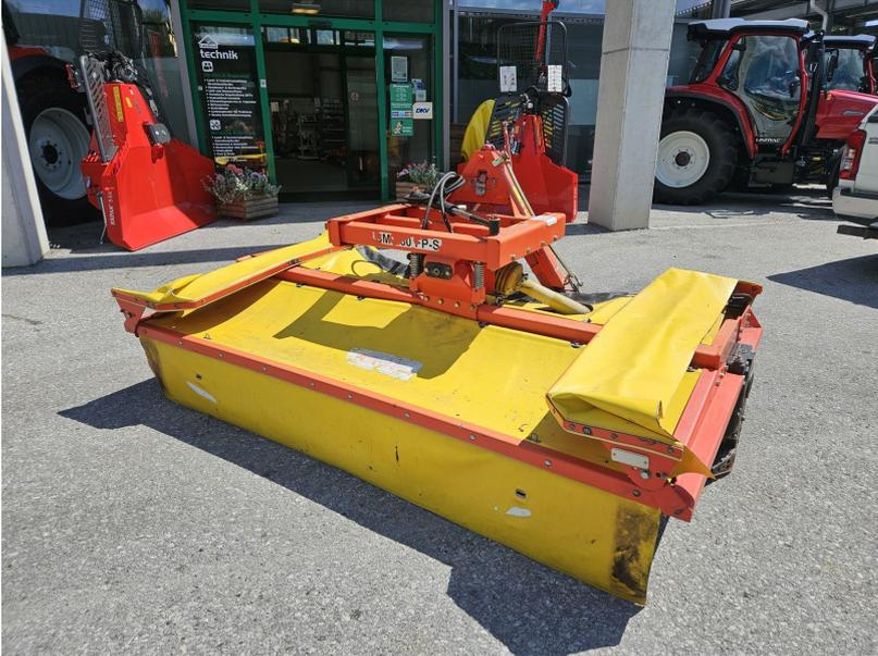
Scheibenmäherwerk mit Seitenverschub und Federn;
