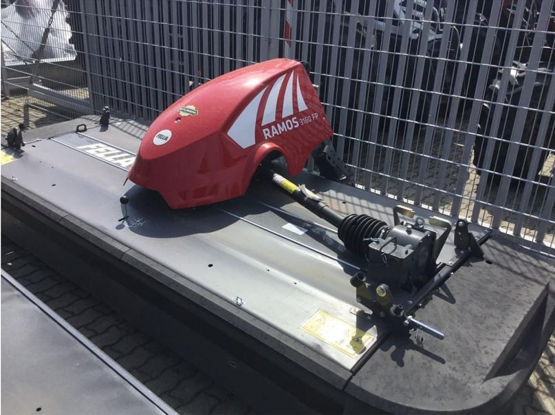
Frontmäherwerk mit 316cm Arbeitsbreite
