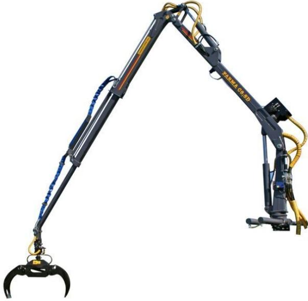
Reichweite 8,3 m, Hubkraft in kg bei voll ausgezogener Länge (exkl. Greifer, Drehgelenk) 520kg, Drehmoment 16 kNm, Drehwinkel Kran 360 Grad, Teleskop-Hublänge 3 m, Empfohlener Fluss 40-70 l/min, Arbeitsdruck 190 bar, Hubkapazität netto 45 kNm;
