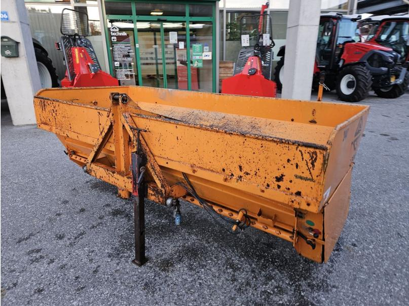
Dreipunkt Nachlaufstreugerät, Welle teilweise geschweißt, aber funktionsfähig.
