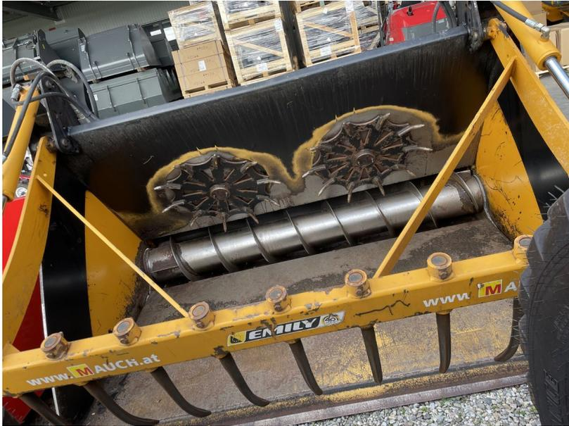
Emily Omega mit hydraulischen Greifer, Entwirrungsräder, Rechts und Links
