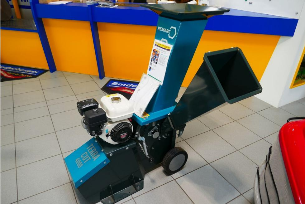
Remarc Terra Cut 4000 Gartenhäcksler, Honda Motor 3,6 kW, ca. 650 kg pro Stunde Häckselleistung, bis 60 mm Aststärke, Grob-/Feineinstellung für nass oder trocken, Zweikammer-Schneidverfahren, Messeranzahl: 12, ca. 80 kg Eigengewicht, seitlicher Zugang für schwere Objekte, Siebhebel zum öffnen und schließen, Hammerwerk zum perfekten verkleinern, Ausstellungsmaschine, prompt verfügbar.
