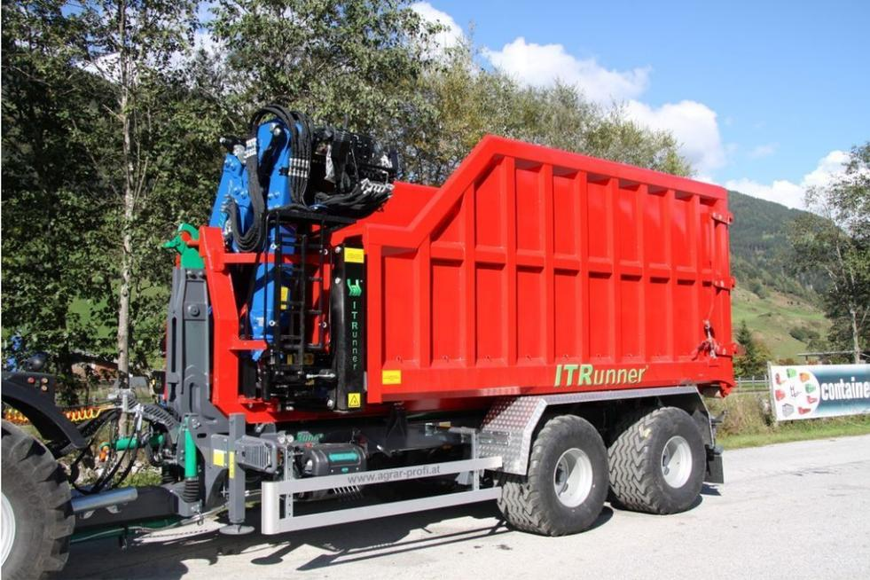
Krancontainer in verschiedenen Ausführungen 6.500 x 2.350 x 2.400mm mit B.O.B Italev Kran 9,3m Reichweite, Hochsitz, LoadSensing, Profi Holzzange, Komplett aus Hardox 450 gefertigt, kann vorwärts oder Rückwärts aufgezogen werden
