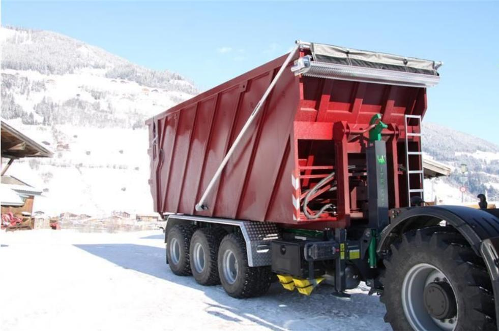
Abschiebecontainer mit hydr. Volumenheckklappe, mit Quick-Cover Rollplanensystem, Erforderliche Ölmenge ca. 26 Liter, Entladezeit für einen 36m<sup>3</sup> Container etwas unter 45 Sekunden, Eigengewicht liegt bei knapp über 4.000 kg, Mehr Info sowie ein Video unter [www.containerprofi.at](http://www.containerprofi.at)
