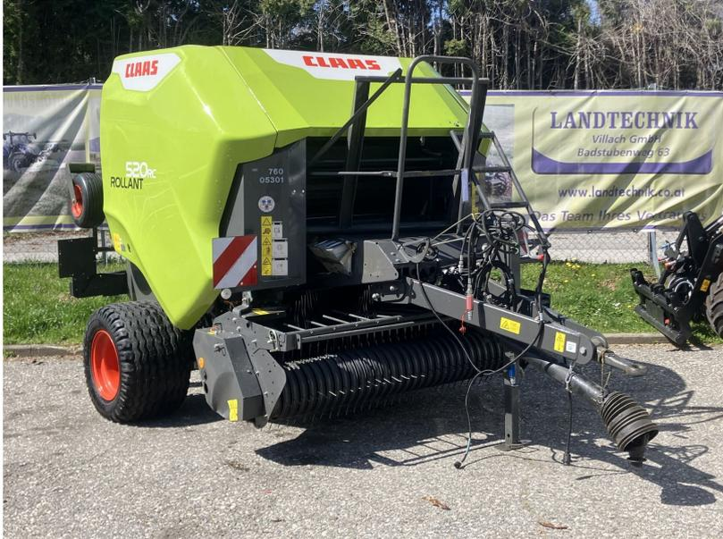
Claas Rollant 520 RC mit Maximum Pressure System(MPS) ca. 1950 Ballen, 210 cm breite Pickup mit Tasträder, automatische Schmierung, 14 Messer Schneidwerk mit Einzelmessersicherung, Komfortbedienung, Netzbindung, Weitwinkel-Gelenkwelle mit Nockenschaltkupplung, Ballenauswerfer, Bereifung:480/45-17, Beleuchtung, neuwertiger Zustand, sofort verfügbar.
