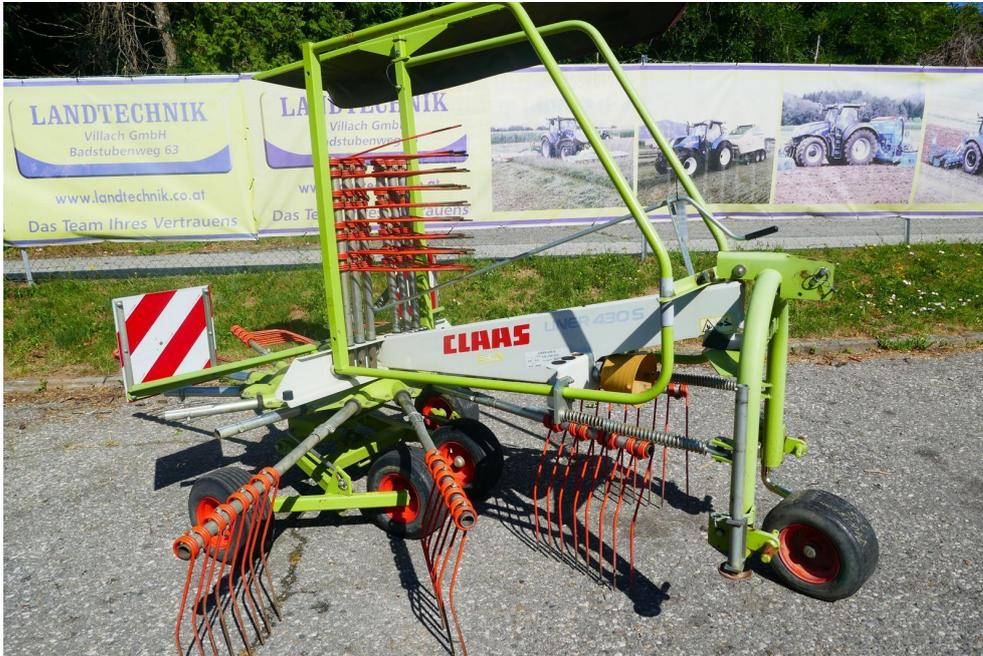
Claas Liner 430 S, Einkreiselseitenschwader mit Tastrad, Tandemachse, Schwenkbock mit Dämpfungsstreben, 13 Zinkenarme mit je 4 Doppelzinken alle Arme abnehmbar, klappbare Schutzbügel, Schwadentuch nicht beschädigt, ungeschweißter Originalzustand, Gelenkwelle - sofort verfügbar.
