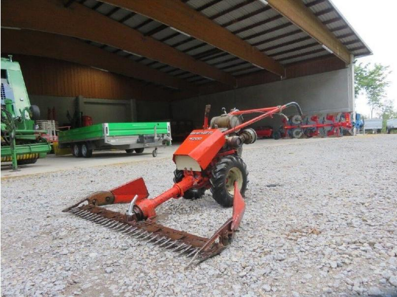
Mittelschnitt Fingerbalken 145cm, 2 Gang, MAG 4 Takt Motor
