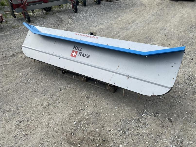
Arbeitsbreite 250 cm, passend für Brielmaier-Motormäher, hydr. schwenkbar, sofort einsatzbereit.
