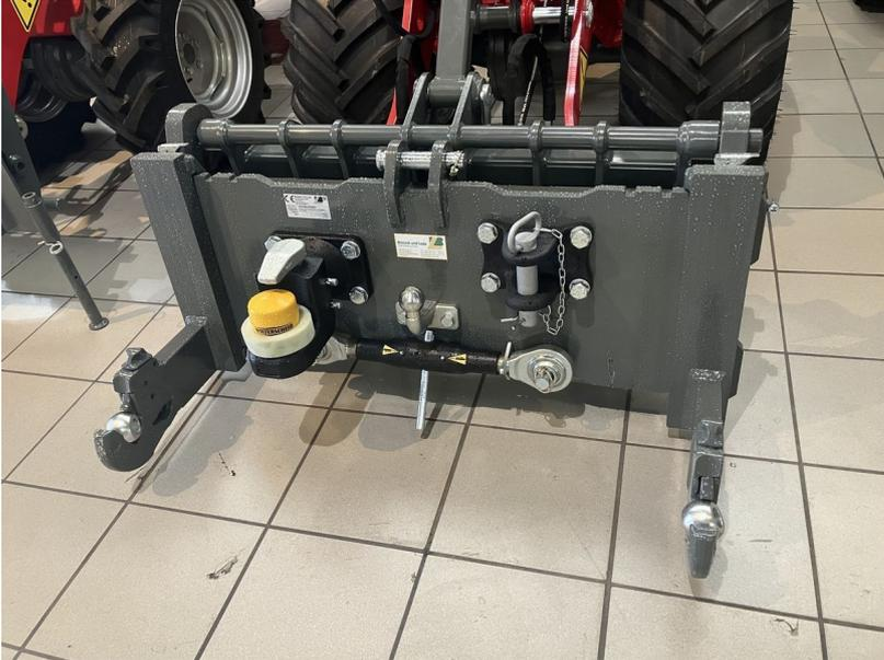
Der Adapterrahmen ermöglicht das Aufnehmen von 3-Punkt-Anbauwerkzeugen, Anbauwerkzeugen mit Schlepperdreieck, bzw. Geräte mit der kommunalen Anbauplatte an Kleintraktoren, Hoflader, Radlader, Teleskoplader oder Bagger mit Schnellwechsler.
