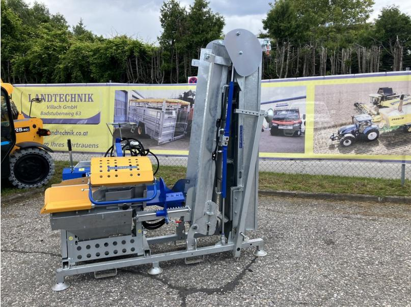
Binderberger „Made in Austria“; Förderband-Kreissäge WS 700, mit Zapfwellenantrieb und mechanischer Wippe, 700 Ø Hartmetall Sägeblatt, für Traktoranbau auf 3-Punkt, mit Förderband 4 m, hydr. klappbar, inkl. Gelenkwelle, Ausstellungsmaschine, prompt verfügbar.
