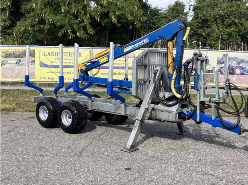
Binderberger Rückewagen RW 8, Doppelrahmen-Anhänger, Forstkran FK 6300 mit Schwenkwerk, Stehpodest mit Kreuzhebelsteuerung mit Drehfunktion, mit Profigreifer 1200, Rotator, Untenanhängung mit hydr. Schwenkdeichsel, 4 Rungenpaare, mit hydraulischer Bremse, Bereifung: 400/60-15.3 mit Felgen und Ventilschutz, Beleuchtung, prompt verfügbar.
