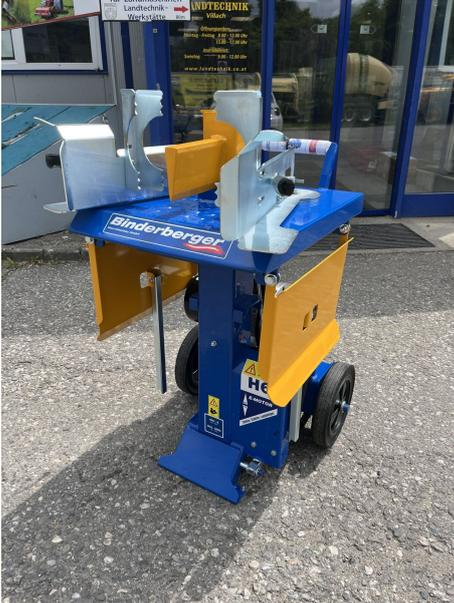
Binderberger „Made in Austria“; Kurzholzspalter H 6 E mit 4 kW Motor, 16 A Stecker, Tischvergrößerung beidseitig mechanisch klappbar, 2 Transporträder mit Handbedienung, prompt verfügbar.
