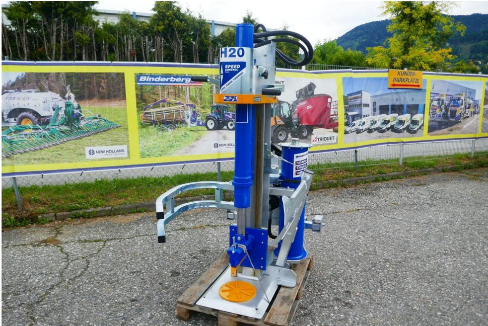
Binderberger H 20 Z stehender Meterholzspalter mit beweglichen Spaltnesser auf 3-Punkt Anbau, mit Gusspumpe und Zapfwellenantrieb, verzinkte Ausführung, Drehteller, mech. Stammheber, Schutzbügel, Gewicht: 530 kg, Spaltlänge: 115 cm, prompt verfügbar.
