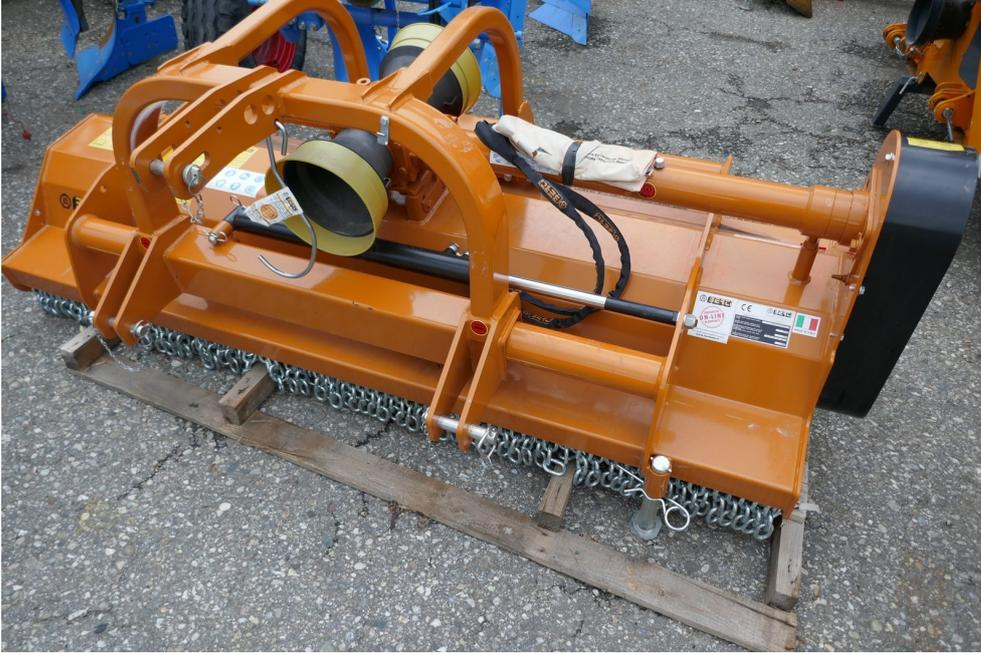
Berti EKR/S 220, Front oder Heckmulcher Mulcher mit Hammerausführung, Bodenstützwalze vorne mit Kettenschutz, hydraulische Seitenverstellung, Getriebe mit Freilauf, Gelenkwelle als Option, Lieferung nach Vereinbarung
