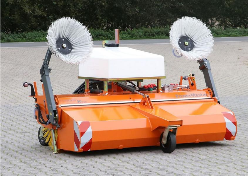
Bema 30 Dual Kehrmaschine in verschiedenen Breiten von 1850mm - 2600mm.
