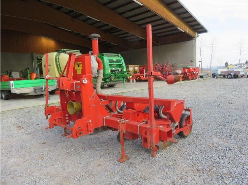
4-reihige Maissämaschine Aeromat, Flexdruckrollen, V-Vorsatzscheibenschar, Spuranzeiger
