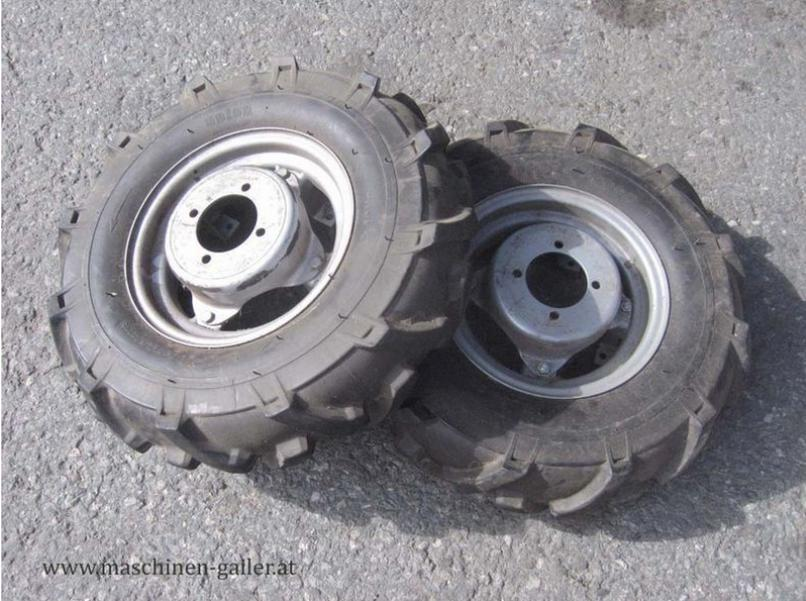
5.00-10 80% Die gebrauchten Kompleträder sind passend zu BCS und verfügen über eine Felge mit 4 Löcher/11mm, einen Nabendurchmesser von 74mm sowie einen Lochkreis von 94mm.
