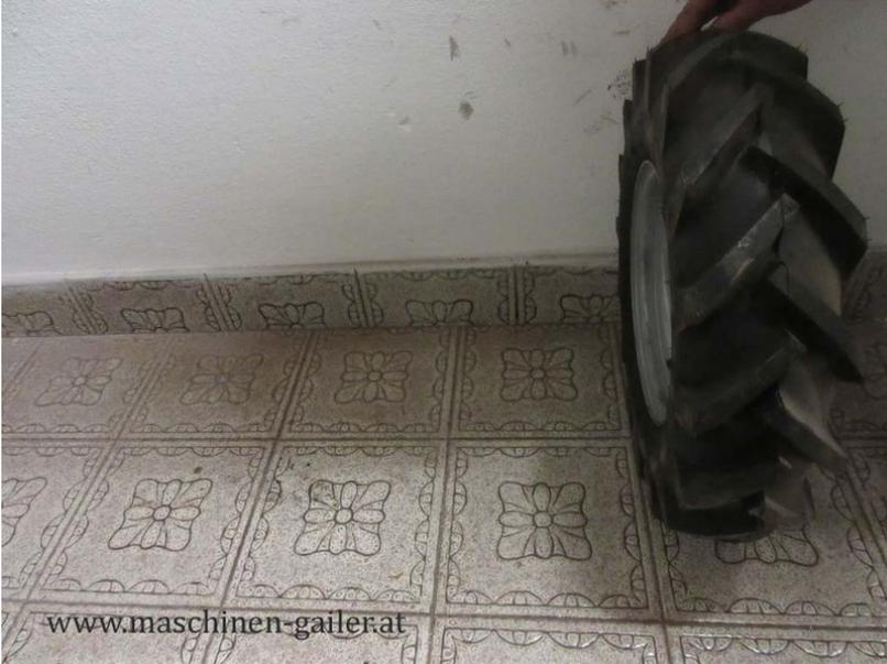
Es handelt sich um eine Garnitur Räder mit der Dimension 4.00-8. Sie sind neu und sind passend zu einem BCS Motormäher 610, 615 und 620, Aebi BM 5 und 8 und Refürm 616, 621.
