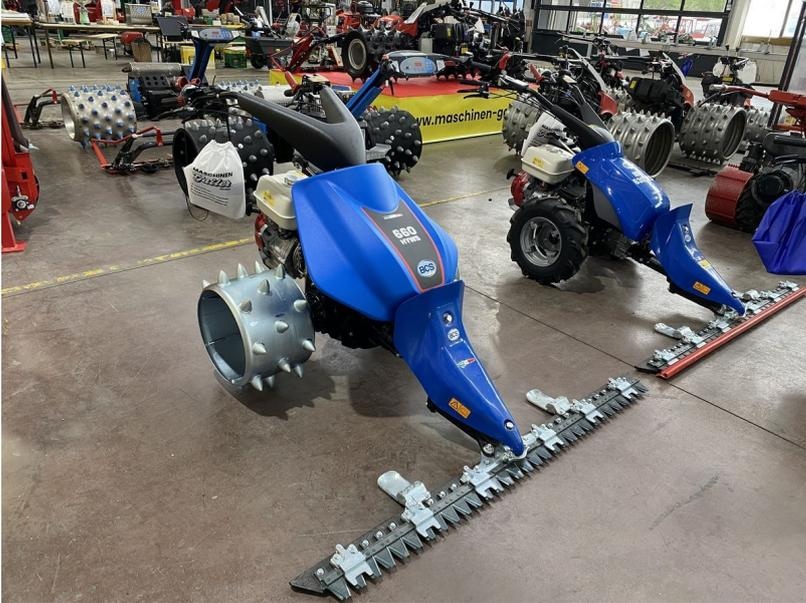
Motormäher mit hydrostatischem Getriebe (CVT) und PowerSafe®-Hydraulikkupplung.
