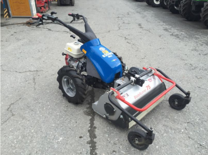
Diese Maschine ist ausgestattet mit einem 75 cm breiten Mulchgerät Blade Runner und Lenkbremsen. Getriebe 4 Vorwärts und 3 Retourgänge. Motor Honda 11 PS.
