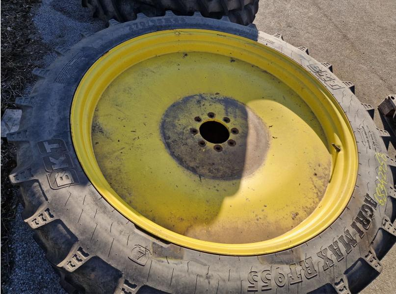
Klassifizierung: Gebrauchtmachine; Reifentyp: Rad; Anbauposition der Räder/Reifen: kompletter Satz; Vorderreifen Hersteller: Alliance; Hinterreifen Hersteller: Alliance; Vorderreifen Größe: 270/80R32; Hinterreifen Größe: 270/95R46; Weitere Maschinenmerkmale: HA: Nabendurchmesser 155mm, Lochkreisdurchmesser 203mm, 8 Bolzen
