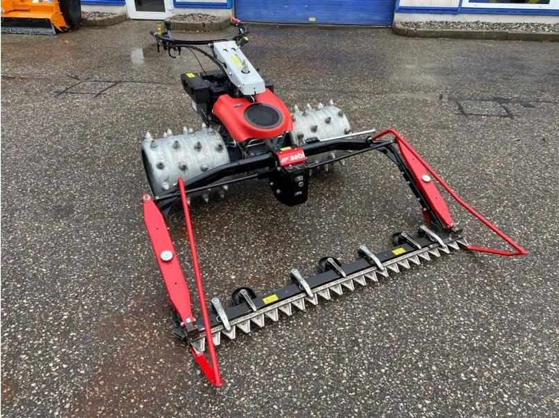
Aebi CC 36 Hydro Motormäher mit 4-Takt-Motor, 14 PS, Hydroantrieb, 3 stufig verstellbar, mit Ölkühler, Lenkbremse, Lenkhebellenkung, mit 4-reihigen Stachelrädern, mit Portalachsmähwerk 1,6 m, 1 Satz Reservemessern, Vorführmaschine, Standort: Lieserbrücke, prompt verfügbar.
