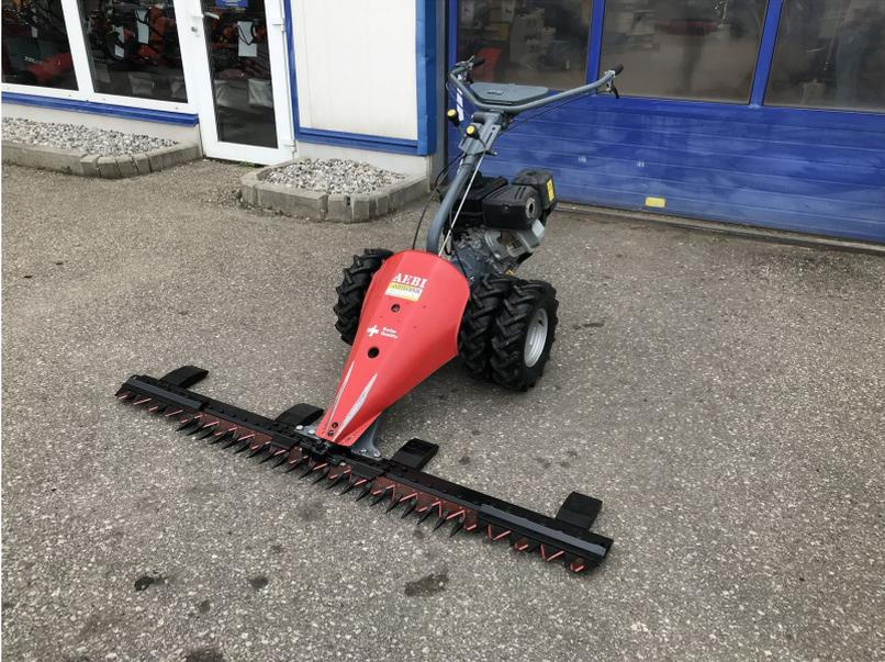
Aebi Motormäher CC 16 mit 4-Takt Motor, 2 Ganggetriebe, Freischnittmähbalken 1,75m, mit 4 Gewichtssohlen, Gummibereifung und Gummi Zwillingsbereifung, einwandfrei betriebsbereit und werkstattgeprüft, Standort: Lieserbrücke, prompt verfügbar.
