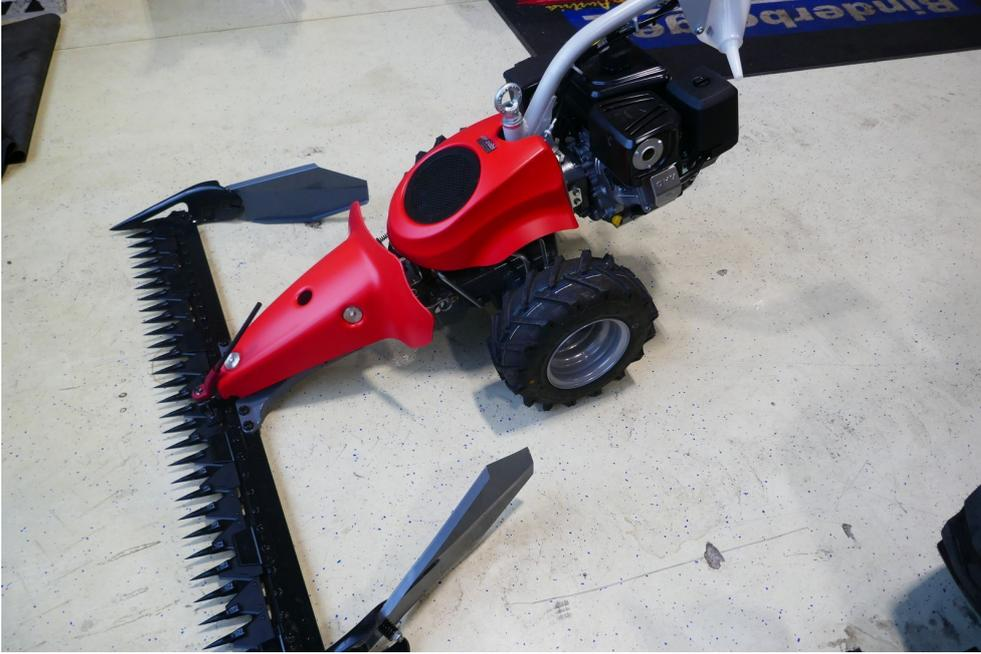
Aebi Motormäher CC 110 Hydro, mit 8 PS 4-Takt-Motor, Ballonbereifung 6x6,50-8, 1,60 m Fingerbalken mit Schwadbleche, Reservemesser, Lenkhebel-Lenkung, Ölkühler, neuestes Modell, prompt verfügbar.
