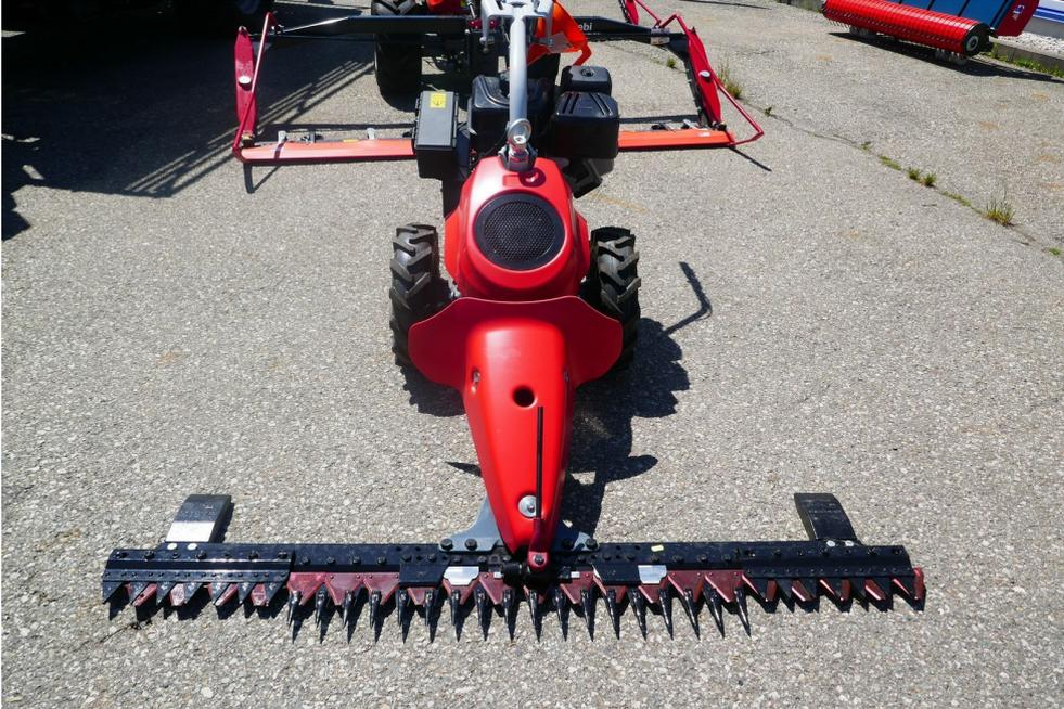
Aebi Motormäher CC 110 Hydro, mit 8 PS 4-Takt-Motor, Gummibereifung 4.80/4.00-8, 1,75 m Freischnittbalken mit 2 Gewichtssohlen und Reservemesser, Lenkhebel-Lenkung, Ölkühler, Ausstellungsgerät, Standort: Lieserbrücke, prompt verfügbar.
