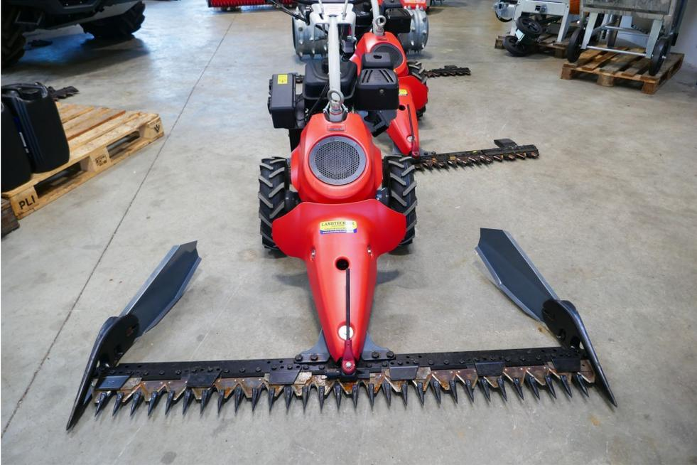
Aebi Motormäher CC 110 Hydro, mit 8 PS 4-Takt-Motor, Gummibereifung 4.80/4.00-8, 1,60 m Fingerbalken mit Schwadbleche, Reservemesser, Lenkhebel-Lenkung, Ölkühler, 24 Monate Sorglospaket, Ausstellungsgerät, Standort: Lieserbrücke, prompt verfügbar.
