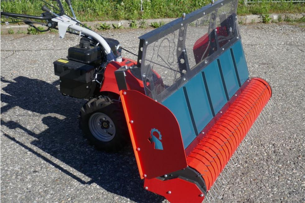
Aebi Motormäher CC 110 Hydro Grundmaschine mit AlpFlow 158 Pick-up Schwader mit Förderband für links und rechts zum umschalten, Seitenbleche verstellbar und Tasträder zur Höheneinstellung, geringes Eigengewicht, hohe Leistung bei Heu, Vorführmaschine, prompt verfügbar
