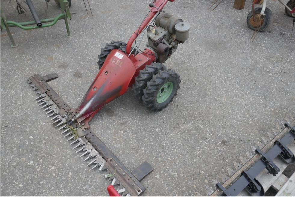
Aebi Motormäher AM 9 mit MAG 4-Takt-Motor, (nicht mehr volle Leistung) 2-Gang-Getriebe, Freischnittbalken 1,75 m mit 2 Gewichtssohlen mit Gummibereifung, mit Gummizwillingsrädern, wie vom Kunden steht; Standort: Lieserbrücke!
