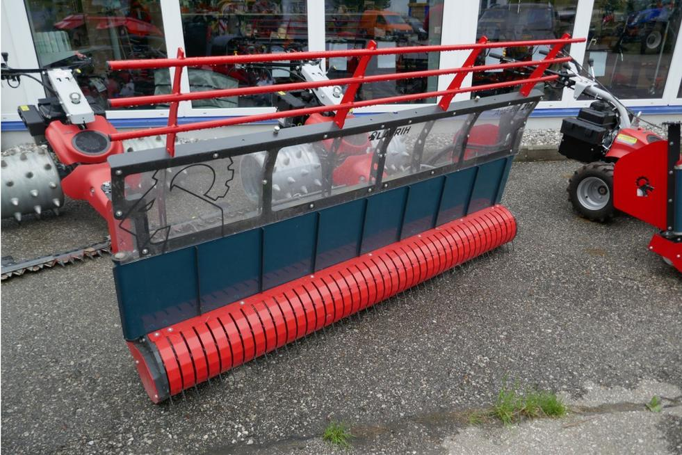
Die große Erleichterung für die Bergbauern Pick-Up Schwader mit Querförderband und Seitenbleche mit Anbauflansch für Aebi Motormäher, Förderband links und rechts umschaltbar, klappbare Seitenschilder, Aufsatz für Schiebeschild, Bodenstützräder verstellbar, ca. 190 kg Eigengewicht, Ausstellungsgerät, Standort: Lieserbrücke, prompt verfügbar!
