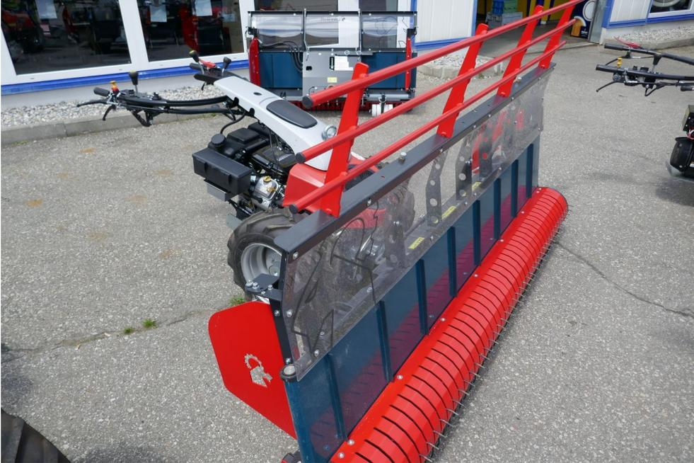
Aebi AlpFlow 218 die große Erleichterung für die Bergbauern Pick-Up Schwader mit Querförderband und Seitenbleche mit Anbauflansch für Aebi Motormäher, Förderband links und rechts umschaltbar, klappbare Seitenschilder, Aufsatz für Schiebeschild, Bodenstützräder verstellbar, ca. 190 kg Eigengewicht, Ausstellungsmaschine, prompt verfügbar.
